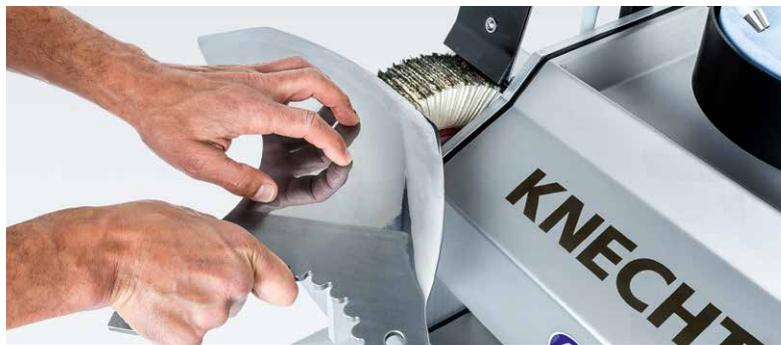
■ Удаление заусенцев и полирование на пластинчатой щетке
