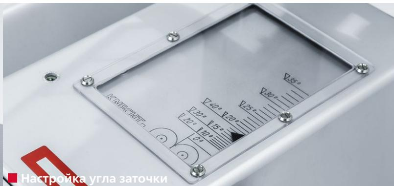
Станок KLA 220–HV 153 II предназначен для заточки плоских и дисковых ножей диаметром от 60 мм до 475 мм с односторонней и двухсторонней заточкой.
