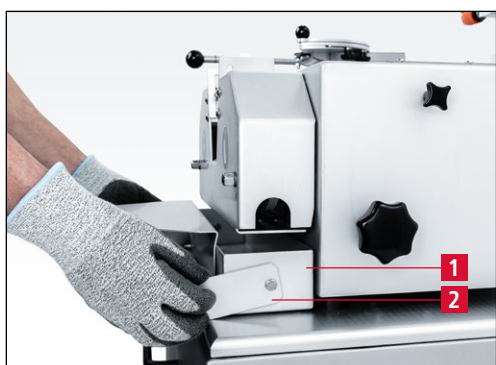
Рис. 7-86 Снятие поддона для воды
