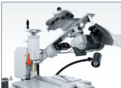
Рис. 7-73 Откидывание приспособления для заточки дисковых ножей в положение зажима
