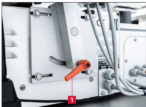
Рис. 7-40 Ослабление зажимного рычага
