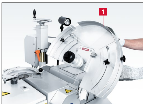
Рис. 7-9 Поворот приспособления для заточки дисковых ножей вправо
