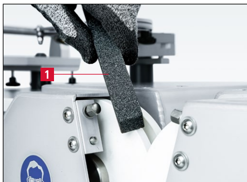
Рис. 7-84 Закругление кромок шлифовального круга
