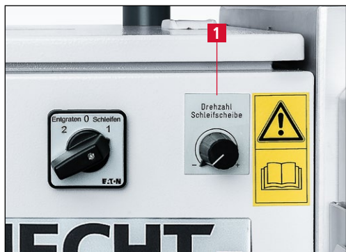
Рис. 7-76 Регулировка частоты вращения правых шлифовальных кругов
