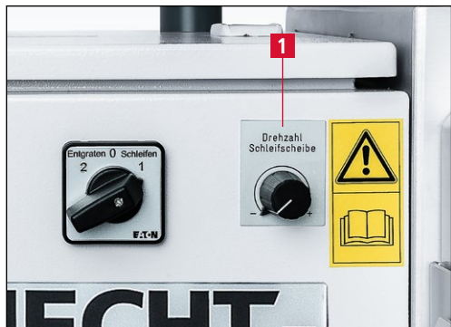
Рис. 7-37 Регулировка частоты вращения правых шлифовальных кругов
