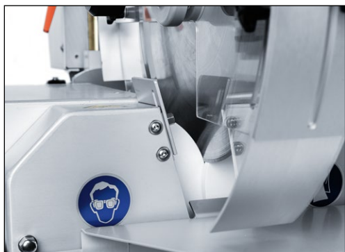
Рис. 7-29 Дисковый нож в зацеплении
