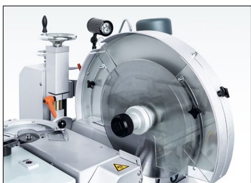
Рис. 7-21 Откидывание приспособления для заточки дисковых ножей вниз
