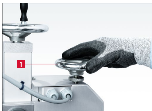
Рис. 7-28 Поворот маховика «Точная подача» против часовой стрелки
