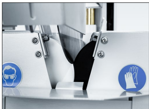
Рис. 7-38 Использование стального диска
