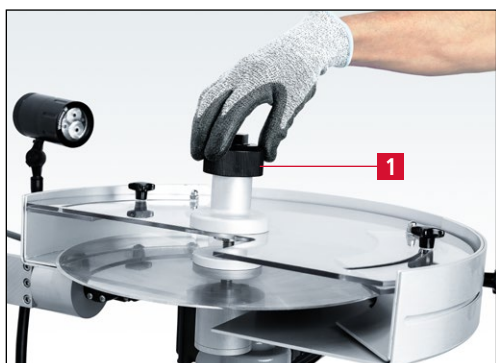
Рис. 7-17 Укладка защитного диска
