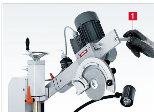
Рис. 7-70 Откидывание устройства для заточки в исходное положение
