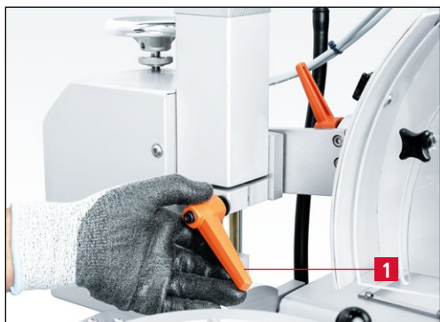
Рис. 7-22 Открывание зажимного рычага «Регулировка высоты»
