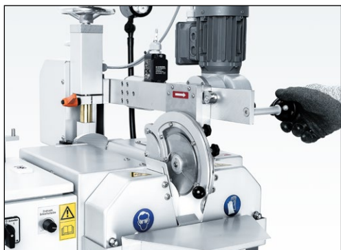
Рис. 7-60 Откидывание приспособления для заточки дисковых ножей вниз
