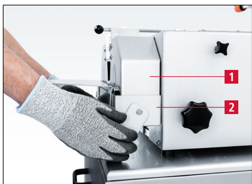
Рис. 7-95 Установка защитного кожуха и поддона для воды
