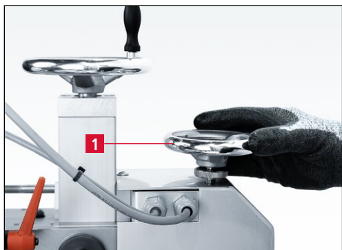
Рис. 7-63 Поворот маховика «Точная подача» по часовой стрелке
