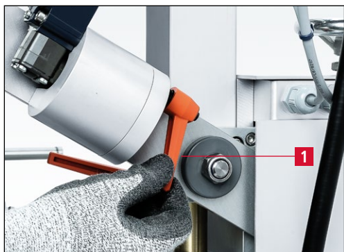
Рис. 7-58 Ослабление зажимного рычага
