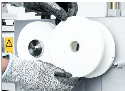
Рис. 7-91 Снятие и замена шлифовальных кругов
