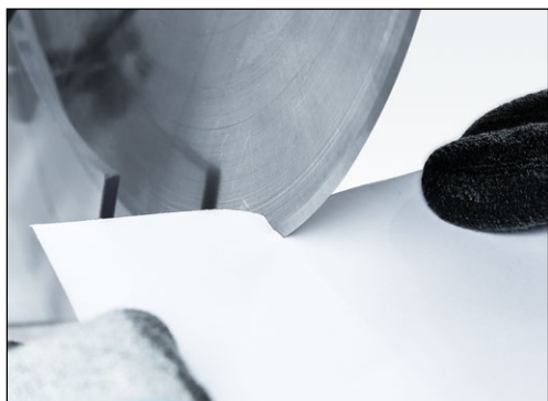
Рис. 7-32 Проверка остроты ножа
