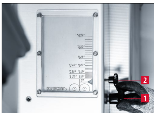
Рис. 7-43 Фиксация стрелки индикатора
