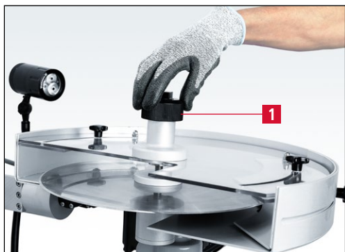
Рис. 7-35 Извлечение дисковых ножей
