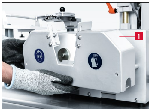
Рис. 7-88 Демонтаж защитного кожуха
