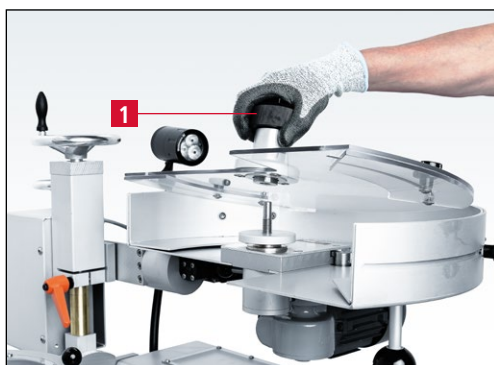
Рис. 7-11 Снятие зажимной гайки с защитным диском
