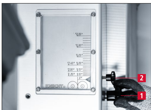
Рис. 7-2 Фиксация стрелки индикатора
