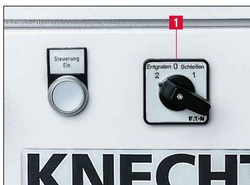
Рис. 7-69 Положение переключателя «Снятие заусенцев»
