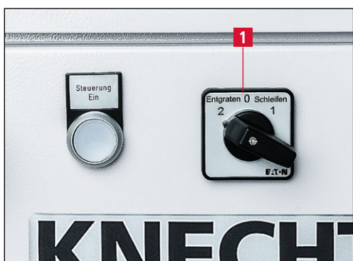
Рис. 7-82 Включение станка для заточки дисковых ножей
