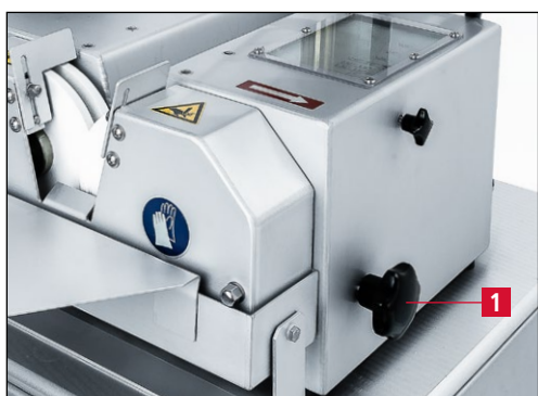
Рис. 7-89 Положение смены шлифовальных кругов
