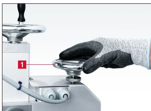
Рис. 7-67 Поворот маховика «Точная подача» против часовой стрелки
