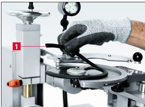
Рис. 7-55 Снятие защиты лезвия
