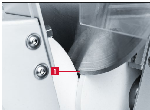
Рис. 7-25 Нож отведен от шлифовальных кругов
