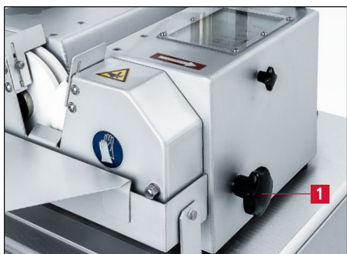
Рис. 7-80 Открывание шлифовальных кругов
