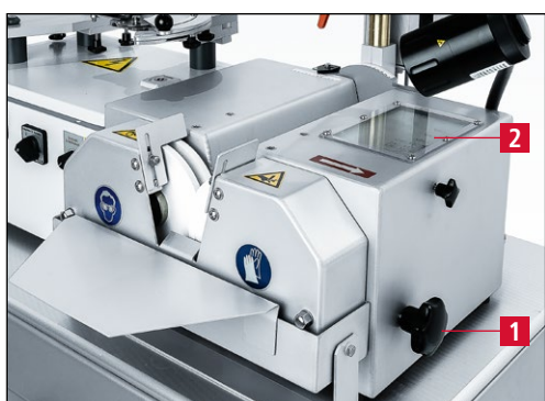
Рис. 7-1 Индикатор угла заточки
