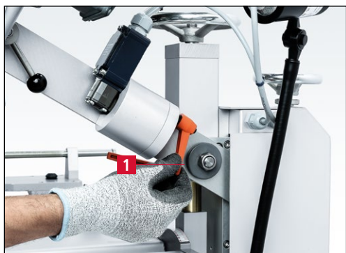
Рис. 7-72 Ослабление зажимного рычага
