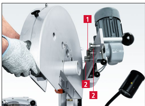
Рис. 7-6 Монтаж крепления дискового ножа
