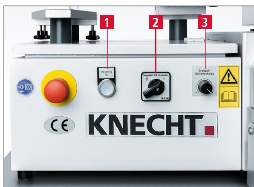
Рис. 7-27 Включение станка для заточки дисковых ножей
