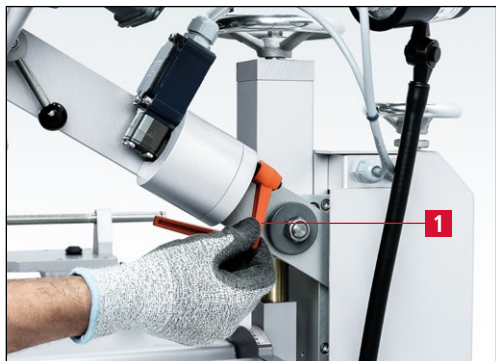
Рис. 7-49 Ослабление зажимного рычага
