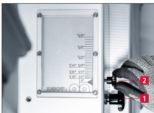
Рис. 7-45 Настройка угла заточки
