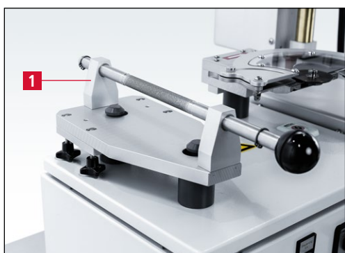
Рис. 7-78 Приспособление для правки HV 156
