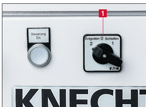
Рис. 7-30 Положение переключателя «Снятие заусенцев»
