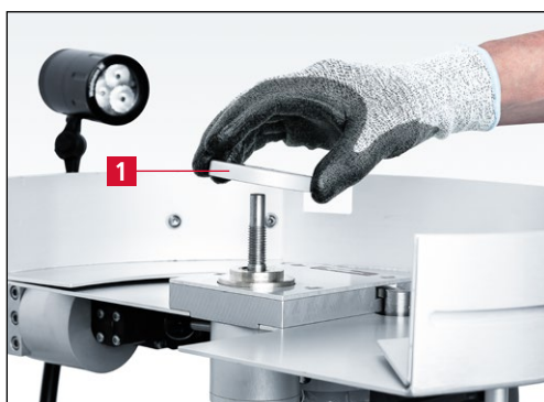
Рис. 7-12 Снятие зажимного фланца
