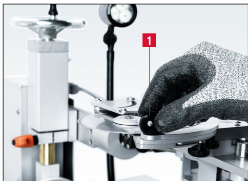
Рис. 7-74 Открывание защитного диска
