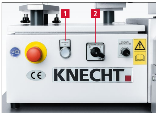
Рис. 6-2 Включение станка для заточки дисковых ножей
