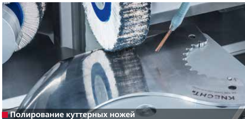
■ Снятие заусенцев с куттерного ножа
