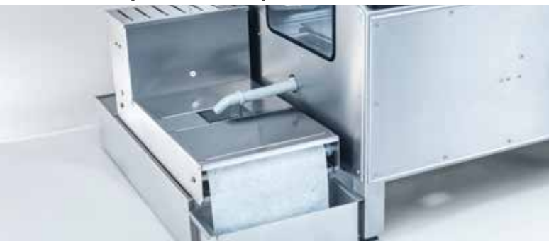
■ Система охлаждения с ленточным фильтром
