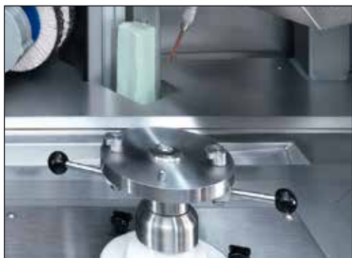
Рисунок 3-12 Крестовой стол, управляемый по трем осям
