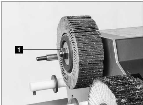
Рис. 1-2 Демонтаж пластинчатого шлифовального круга
