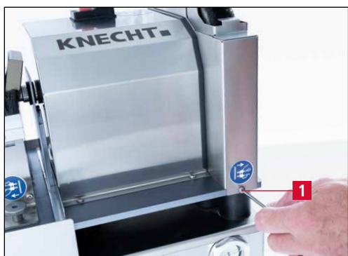
Рис. 7-11 Откручивание крышки полировального круга
