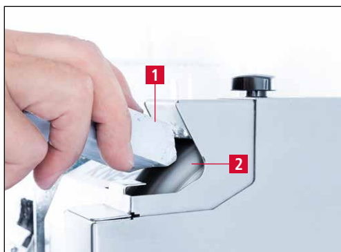
Рис. 7-4 Нанесение полировальной пасты
