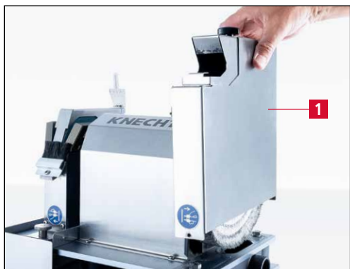
Рис. 7-12 Снятие крышки полировального круга
