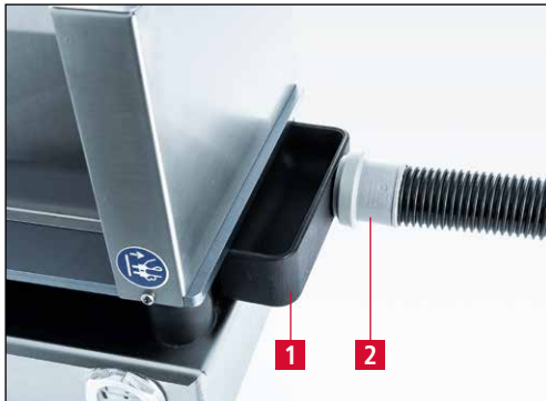
Рис. 3-3 Секция для сбора грязи с отсосным патрубком
