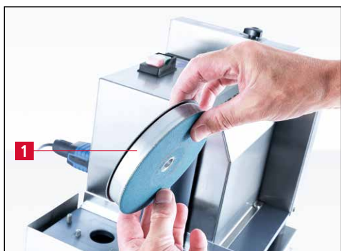
Рис. 7-9 Монтаж новой пары шлифовальных кругов
