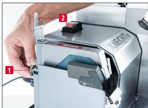
Рис. 7-1 Настройка угла заточки
