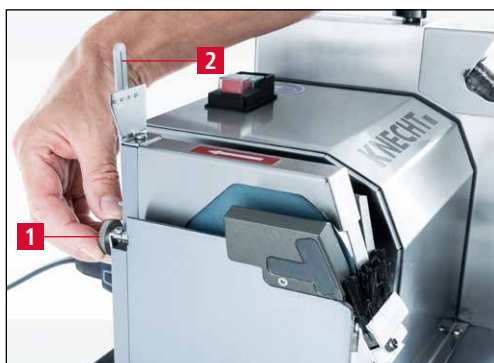
Рис. 7-1 Настройка угла заточки
