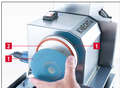
Рис. 7-8 Снятие использованных шлифовальных кругов
