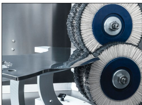
Рисунок 7-9 Регулировка блока для снятия заусенцев
