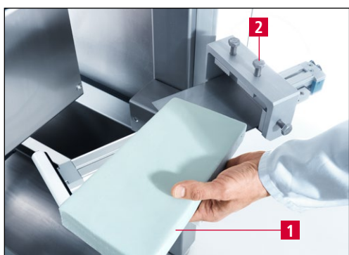
Рисунок 7-24 Замена полировальной пасты слева
