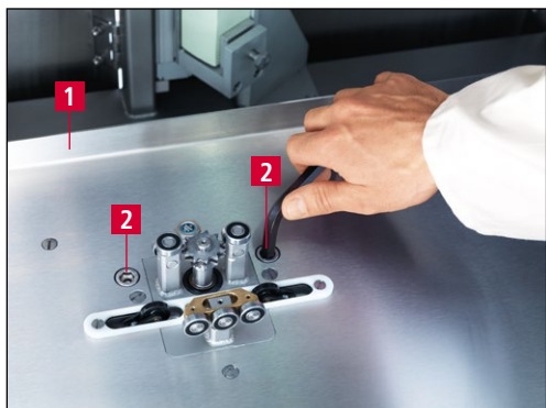
Рисунок 9-7 Демонтаж защитного щитка
