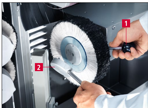
Рисунок 7-20 Замена пластинчатой щетки полировального блока
