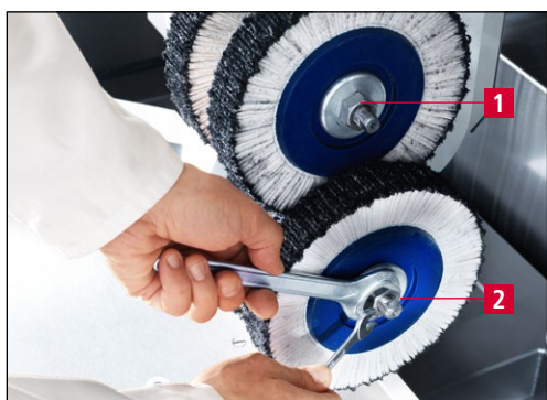
Рисунок 7-22 Замена пластинчатых щеток блока для снятия заусенцев
