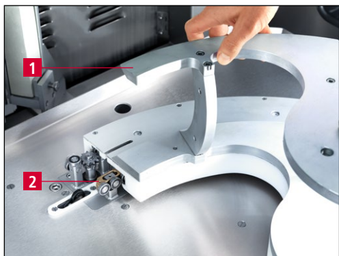
Рисунок 7-16 Сдвигание копировально-шлифовальной плиты на направляющую тележку
