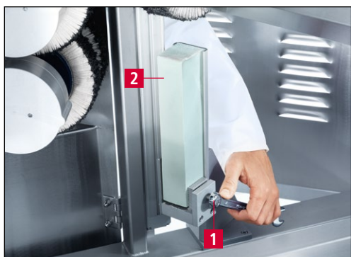
Рисунок 7-23 Замена полировальной пасты справа
