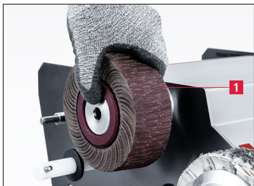
Рис. 7-53 Снятие и замена пластинчатого шлифовального круга
