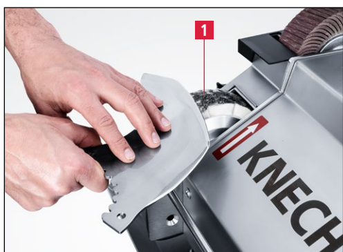
Рис. 7-9 Снятие заусенцев и полирование куттерных ножей
