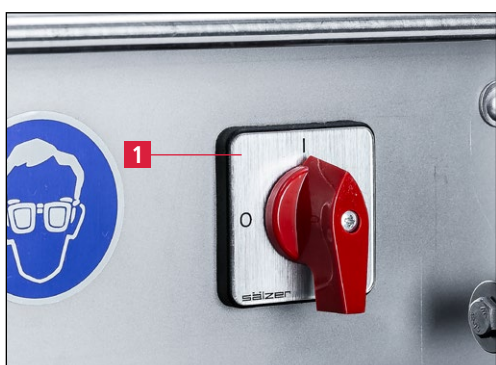
Рис. 7-44 Включение станка для заточки
