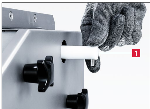
Рис. 7-57 Регулировка подачи охлаждающей жидкости
