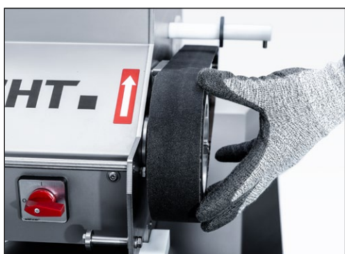
Рис. 7-43 Проверка шлифовальной ленты
