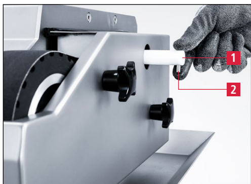
Рис. 7-55 Настройка водяного сопла
