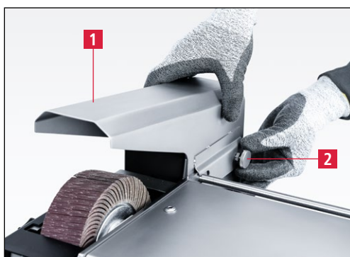
Рис. 7-22 Снятие защиты от брызг
