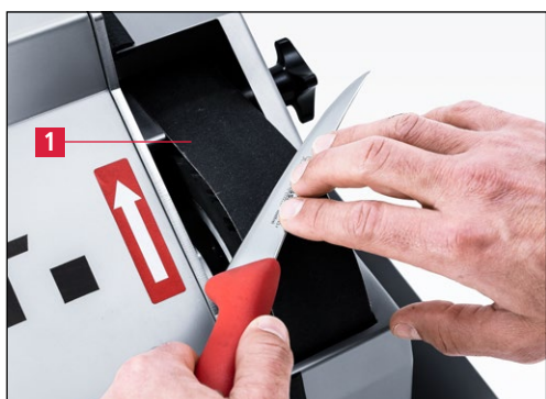
Рис. 7-2 Предварительная заточка ручных ножей
