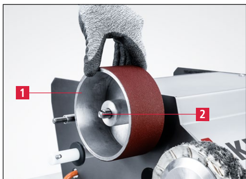
Рис. 7-15 Установка волнистого шлифовального круга
