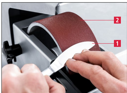
Рис. 7-19 Профилирование столовых ножей
