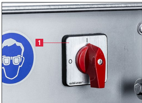
Рис. 7-17 Включение станка для заточки
