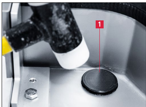
Рис. 7-25 Снятие запорной крышки
