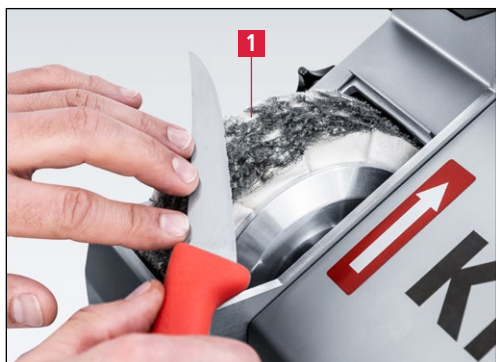
Рис. 7-5 Снятие заусенцев и полирование ручных ножей
