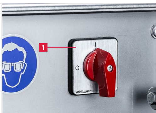
Рис. 7-1 Включение станка для заточки
