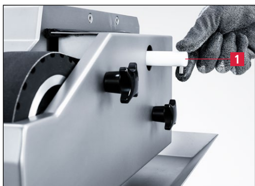
Рис. 6-4 Регулировка подачи охлаждающей жидкости
