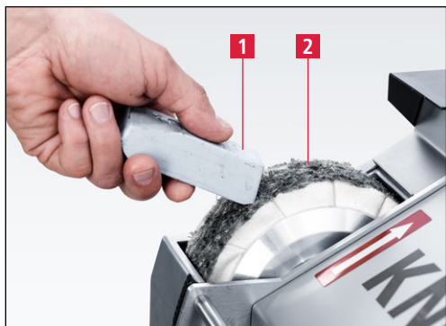
Рис. 7-8 Нанесение полировальной пасты
