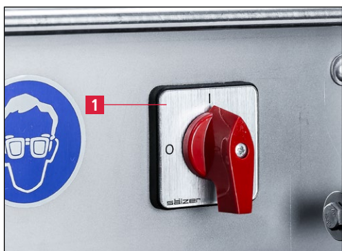
Рис. 6-2 Включение станка для заточки
