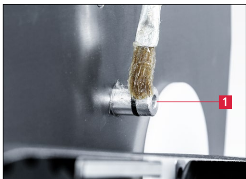
Рис. 7-60 Смазка штуцера охлаждающей жидкости
