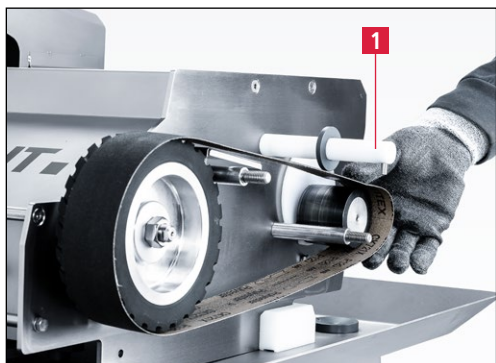
Рис. 7-41 Укладка шлифовальной ленты
