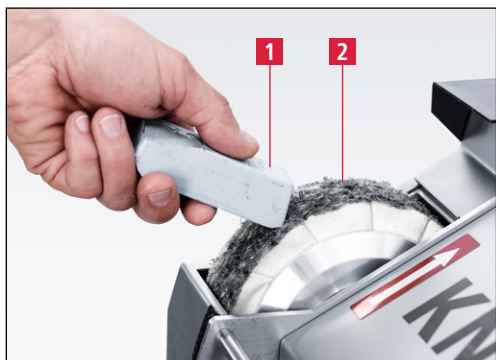
Рис. 7-20 Нанесение полировальной пасты
