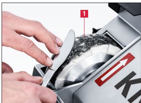
Рис. 7-21 Снятие заусенцев и полирование столовых ножей
