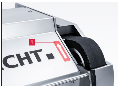
Рис. 6-3 Проверка направления вращения
