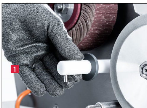
Рис. 7-34 Настройка водяного сопла
