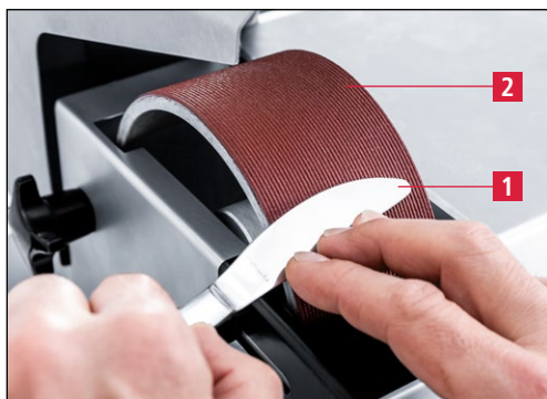
Рис. 7-19 Профилирование столовых ножей
