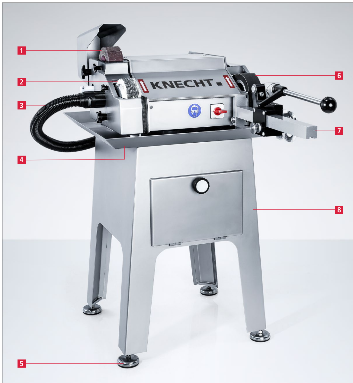
Рис. 3-3 Общий вид станка для заточки (USK 160S, напольное исполнение | HV 161)
