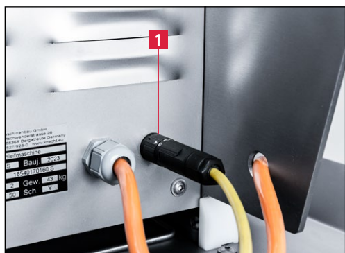
Рис. 7-11 Подключение для промышленного пылесоса
