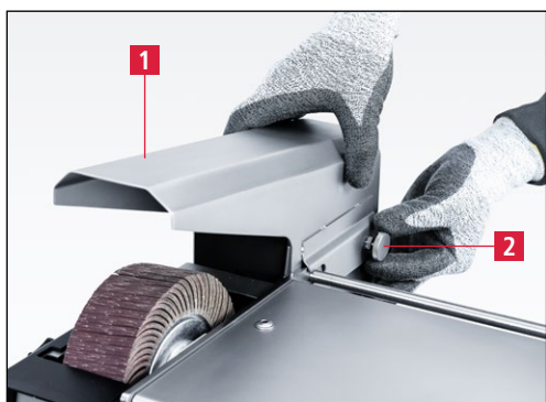
Рис. 7-64 Снятие защиты от брызг
