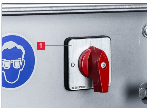
Рис. 7-62 Включение станка для заточки
