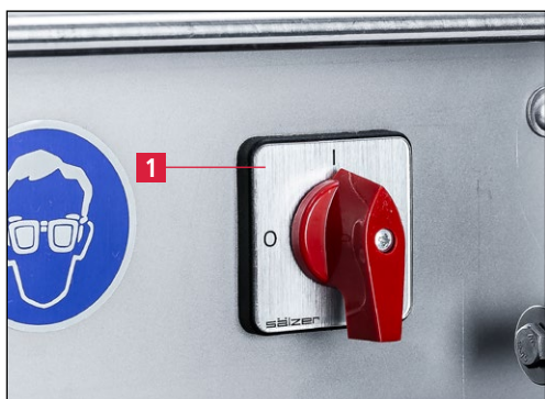
Рис. 7-56 Включение станка для заточки
