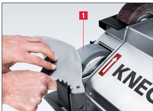
Рис. 7-38 Снятие заусенцев с ножа на увлажняемом доводочном камне
