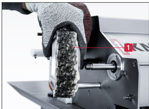
Рис. 7-49 Снятие и замена полировального диска
