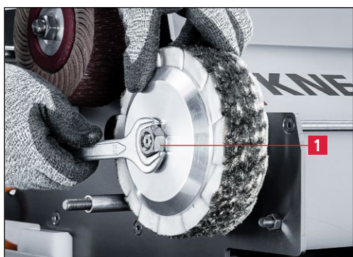
Рис. 7-48 Отсоединение полировального круга
