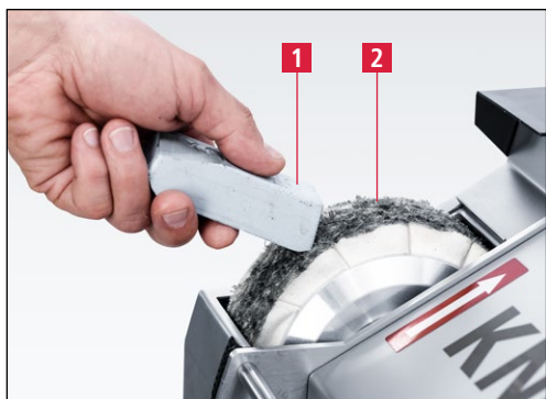
Рис. 7-4 Нанесение полировальной пасты
