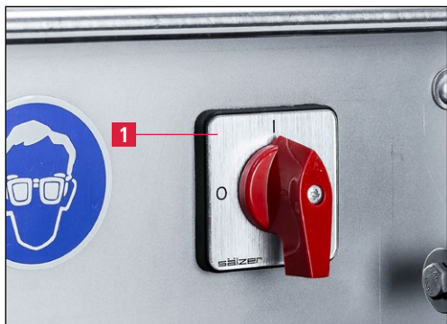
Рис. 7-36 Включение станка для заточки
