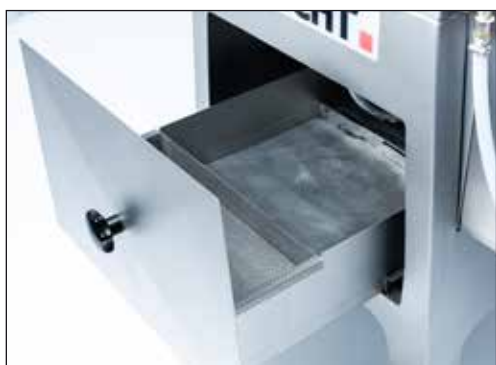
Рис. 6-1 Заполнение системы охлаждения
