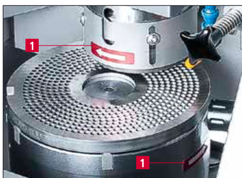
Рис. 6-4 Проверка направления вращения
