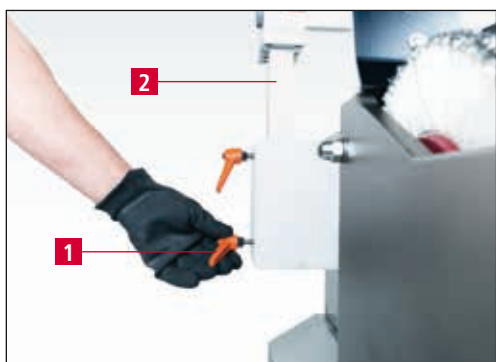
Рис. 7-6 Настройка приспособления для заточки дисковых ножей
