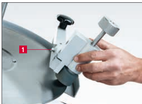
Рис. 7-25 Поворот кронштейна для снятия заусенцев
