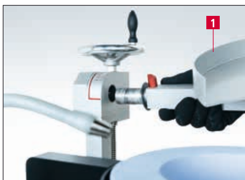
Рис. 6-2 Монтаж приспособления для заточки дисковых ножей HV 205-1 | HV 205-2
