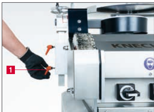
Рис. 7-19 Настройка приспособления для заточки дисковых ножей
