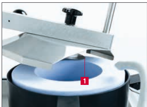
Рис. 7-5 Размещение дисковых ножей на шлифовальном круге
