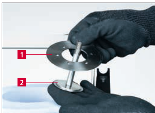
Рис. 7-2 Разместить дисковый нож на подходящем креплении ножа
