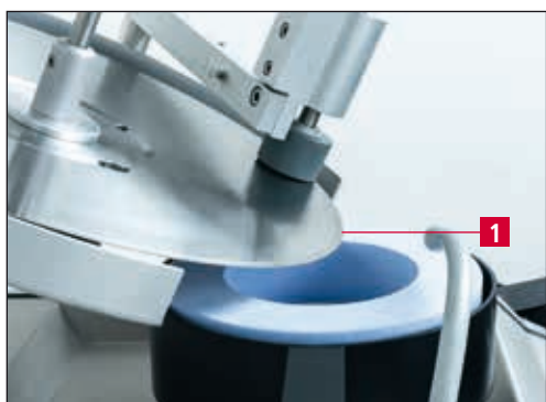
Рис. 7-18 Размещение дисковых ножей на шлифовальном круге
