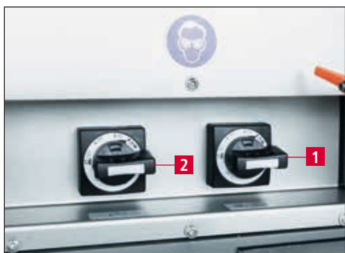
Рис. 7-10 Включение шлифовального станка и системы охлаждения
