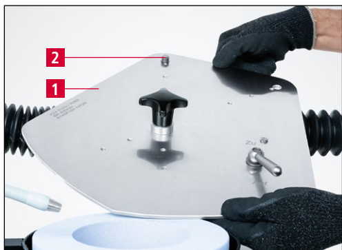
Рис. 7-34 Монтаж шлифовальной пластины
