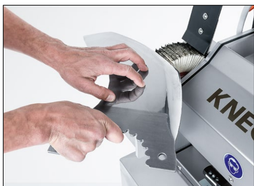
Рис. 9-50 Снятие заусенцев и полирование куттерных ножей на пластинчатой щетке
