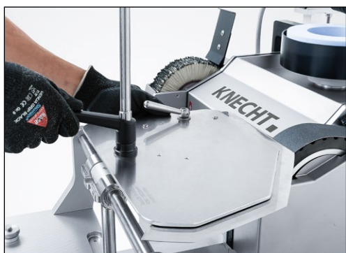
Рис. 9-17 Выравнивание ножа на шлифовальной ленте
