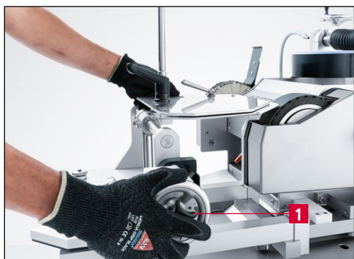
Рис. 9-15 Перемещение устройства для заточки к шлифовальной ленте
