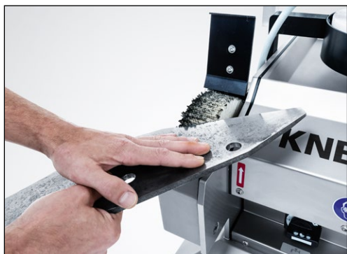
Рис. 7-21 Снятие заусенцев и полирование линейных ножей на пластинчатой щетке
