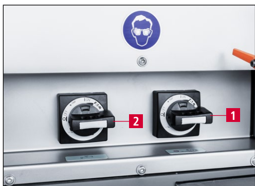
Рис. 7-22 Включение станка для заточки и системы охлаждения
