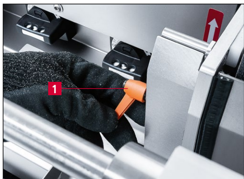
Рис. 8-3 Фиксация устройства для ленточной заточки
