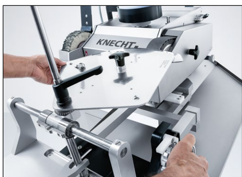
Рис. 9-42 Перемещение устройства для заточки к шлифовальной ленте
