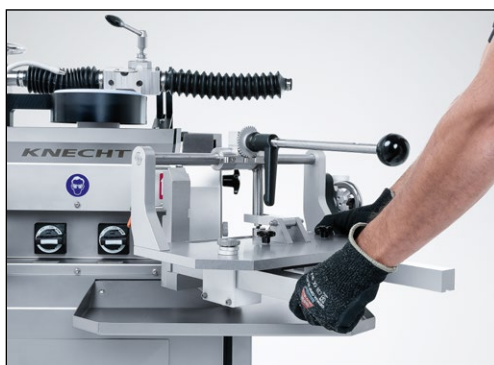
Рис. 8-2 Поворот устройства HV 262 в рабочее положение
