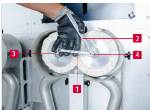
Рисунок 7-15 Замена колец для полирования / снятия заусенцев
