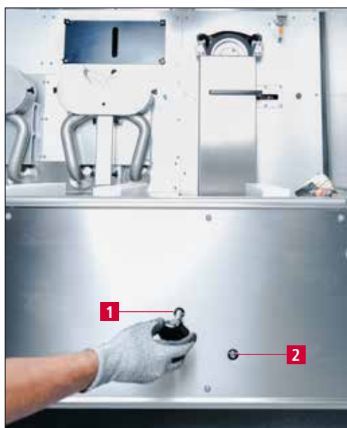
Рисунок 7-13 Выравнивание ленты для влажного шлифования
