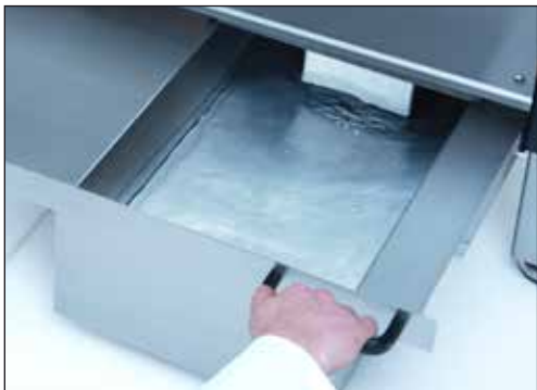
Рисунок 7-22 Замена охлаждающей воды
