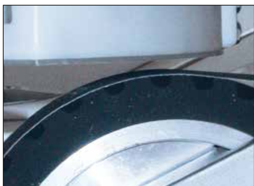
Рисунок 6-4 Расстояние от ножа до ленты для влажного шлифования
