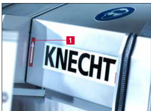
Рисунок 6-2 Проверка направления вращения
