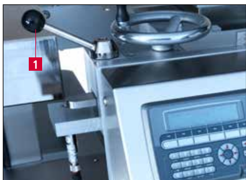
Рисунок 7-2 Поворот копировально-шлифовального устройства в сменное положение
