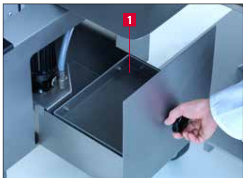
Рисунок 6-1 Заполнение резервуара для воды
