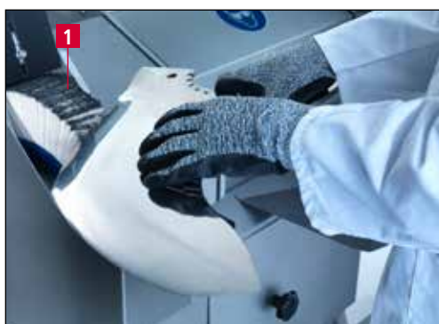
Рисунок 7-13 Полирование/снятие заусенцев с куттерного ножа
