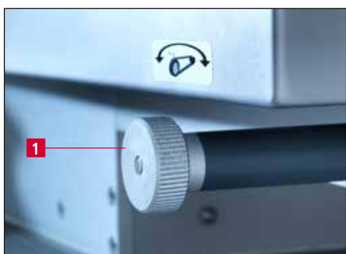
Рисунок 7-18 Механизм регулировки ленты
